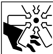
CORTE DE DEDOS O DE LA MANO, VENTILADOR DEL MOTOR
