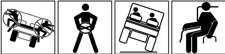
SPRING IKKE NED FRA MASKINEN, HVIS DEN ER VED AT VÆLTE HOLD GODT FAST OG STEM FØDDERNE MOD GULVET MAN SKAL LÆNE SIG VÆK FRA DEN SIDE, MASKINEN HJELDER IMOD HOLD FAST I HØFTEFASTSPENDINGSANORDNINGEN OG HÅNDTAGET, STEM FØDDERNE MOD GULVET
