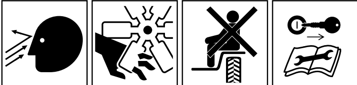
FARE FOR ANSIGTET FRA UDKASTEDE ELLER FLYVENDE GENSTANDE RISIKO FOR LEMLÆSTELSE AF FINGRENE ELLER HÆNDERNE FRA MOTORVENTILATOR PÅ MASKINER MED SIDDENDE FORER MÅ DER KUN KØRES MED EN PASSAGER, HVIS DER ER ET PASSAGERSÆDE OG FORERENS UDSYN IKKE ER SPÆRRET INDEN DER UDFØRES VEDLIGEHOLDELSSES- ELLER REPARATIONSARBEJDE, AFBRYD MOTOREN OG FJERN NØGLEN.
