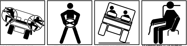
NO SALTE AL VOLCAR LA MAQUINA MANTENGASE FIRME Y TENSE LOS PIES APOYESE CONTRA LA INCLINACION AGARRARSE BIEN A LAS BARRAS DE PROTECCION Y APOYE FIRMEMENTE LOS PIES.
