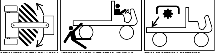
PERMANEZCA FUERA DE LA ZONA DE ARTICULACION CON EL MOTOR EN MARCHA ATROPELLO ADELANTE/ATRAS, VEHICULO TOMA DE POTENCIA POSTERIOR
