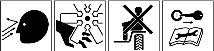
OBJETOS ARROJADOS O VOLANTES, ROSTRO EXPUESTO CORTE DE DEDOS O DE LA MANO, VENTILADOR DEL MOTOR SOLO SE PUEDE MONTAR EN LA MAQUINA EN EL ASIENTO DEL PASAJERO, Y ESTO UNICAMENTE SI NO SE ESTORBA LA VISTA DEL CONDUCTOR DESCONECTE EL MOTOR Y QUITA LA LLAVE ANTES DE EFECTUAR TRABAJOS DE REPARACION O MANTENIMIENTO
