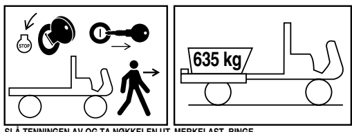
SLÅ AV TENNINGEN AV OG TA NØKKELEN UT FØR DU FORLATER FØRERPLASSEN MERKELAST, BINGE
