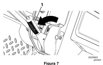
1. Palanca del freno de estacionamiento
