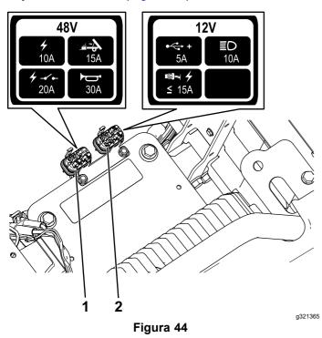
1. Bloque de fusibles de 12 V 2. Bloque de fusibles de 48 V
