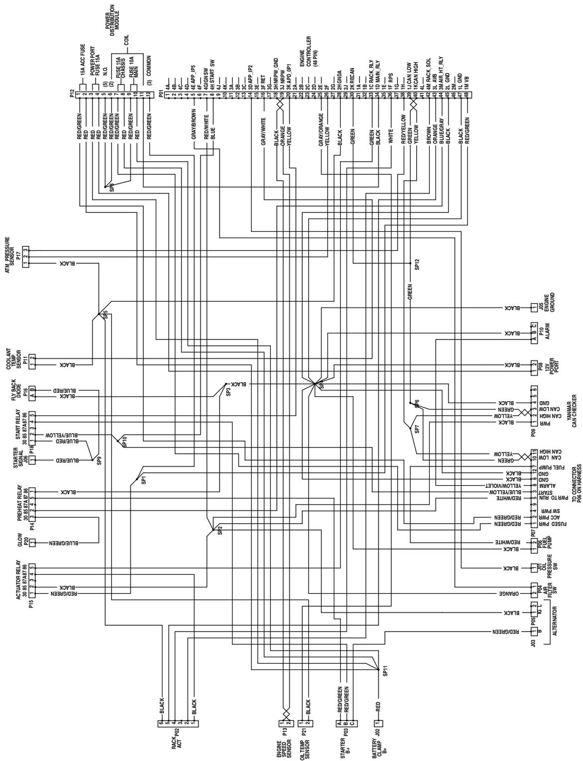
Электрическая схема – двигатель Yanmar 3TNV88C (Rev. A)
