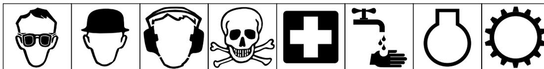
Schutzbrillenpflicht    Schutzhelmpflicht    Ohrenschutzhelmpflicht    Vorsicht, Giftgefahr    Erste Hilfe    Mit klarem Wasser auswaschen    Motor    Getriebe
