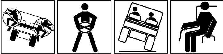
HOPPA INTE AV MASKIN SOM VÄLTER HÅLL I DIG OCH SPJÄRNA MED FÖTTERNA LUTA ÅT ANDRA HÄLLET HOLD HIP RESTRAINT & HAND HOLD, BRACE FEET
