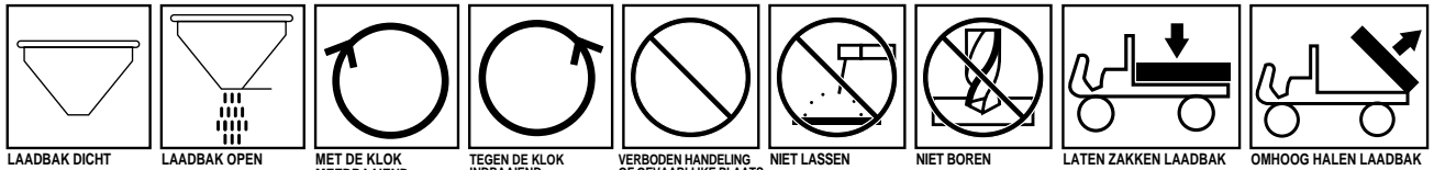
LAADBAK DICHT LAADBAK OPEN MET DE KLOK MEEDRAAIEND TEGEN DE KLOK INDRAAIEND VERBODEN HANDELING OF GEVAARLIJKE PLAATS NIET LASSEN NIET BOREN LATEN ZAKKEN LAADBAK OMHOOG HALEN LAADBAK
