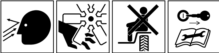
WEGGEWORPEN OF RONDVLIEGENDE VOORWERPEN, BLOOTSTELLING GEZICHT AFSNIJDEN VINGERS OF HAND, MOTORVENTILATOR MEERJUDEN UITSLUITEND TOEGESTAAN OP PASSAGIERSSTOEL INDIEN UITZICHT VAN DE BESTUURDER NIET GEHINDERD WORDT MOTOR AFZETTEN EN SLEUTEL VERWIJDEREN VOORDAT U ONDERHOUD OF REPARATIES UITVOERT
