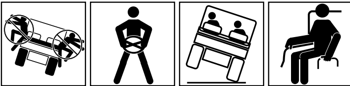
NIET VAN KANTELENDE MACHINE SPRINGEN GOED VASTHOUDEN EN SCHRAPZETTEN TEGENHANGEN HEUPBEUGEL EN HANDVAT VASTHOUDEN, ZET VOETEN SCHRAP
