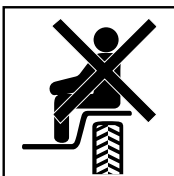
PÅ MASKINER MED SIDDEDE FØRER MÅ DER KUN KØRES MED EN PASSAGER, HVIS DER ER ET PASSAGERSÆDE OG FØRERENS UDSYN IKKE ER SPÆRRET
