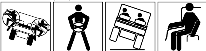
SPRING IKKE NED FRA MASKINEN, HVIS DEN ER VED AT VÆLTE, HOLD GODT FAST OG STEM FØDDERNE MOD GULVET MAN SKAL LÆNE SIG VÆK FRA DEN SIDE, MASKINEN HÆLDER IMOD HOLD FAST I HOFTEFASTSPÆNDINGSANORDNINGEN OG HÅNDTAGET, STEM FØDDERNE MOD GULVET
