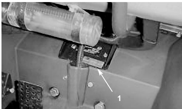
1. Typenschild mit Modell- und Seriennummern
