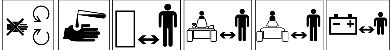
ÄLÄ AVAA TAI IRROTA SUOJAKILPIÄ MOOTTORIN KÄYDESSÄ SYÖVYTTÄVIÄ NESTEITÄ, SORMIEN/KÄDEN PALOVAMMOJEN VAARA PYSY TURVAETÄISYYDELLÄ KONEESTA PYSY TURVAETÄISYYDELLÄ KONEESTA PYSY TURVAETÄISYYDELLÄ KONEESTA PIDÄ LAPSET TURVAETÄISYYDELLÄ AKUSTA
