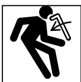
PERICOLO DI ENERGIA IMMAGAZINATA, CONTRACCOLPO O MOVIMENTO VERSO L'ALTO
