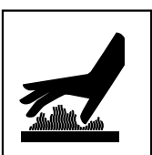
SUPERFICIE MOLTO CALDA. USTIONI A DITA O MANI
