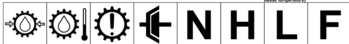
Pression d'huile de transmission Température d'huile de transmission Défaillance/panne de transmission Embayage Point mort Haut Bas Marche avant
