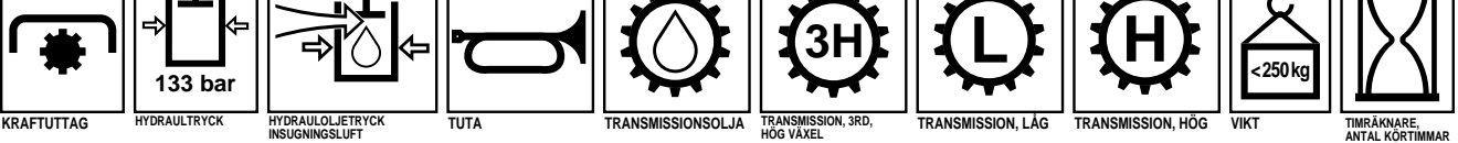
KRAFTUTTAG HYDRAULTRYCK HYDRAULOLJETRYCK INSUGNINGSLUFT TUTA TRANSMISSIONSOLJA TRANSMISSION, 3RD, HÖG VÄXEL TRANSMISSION, LÅG TRANSMISSION, HÖG VIKT TIMRÄKNARE, ANTAL KÖRTIMMAR
