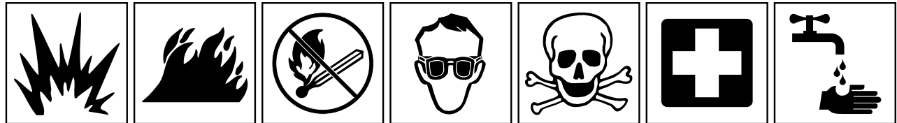
EXPLOSION ELD ELLER ÖPPEN LÅGA ELD, ÖPPEN LÅGA & RÖKNING FÖRBUDEN ÖGONSKYDD MÅSTE ANVÄNDAS VARNING, FÖRGIFTNINGSRISK FÖRSTA HJÄLPEN SPOLA MED VATTEN
