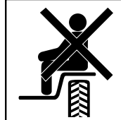
PÅ MASKINER MED SIDDENDE FØRER MA DER KUN KØRES MED EN PASSAGER, HVIS DER ER ET PASSAGERSÆDE OG FØRERENS UDSYN IKKE ER SPÆRRET
