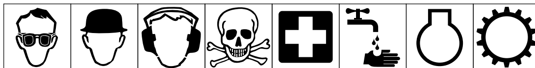
Port de lunettes de sécurité obligatoire Port du casque obligatoire Port de protège-oreilles obligatoire Attention – danger toxique Premiers secours Rincer à l'eau Moteur Transmission
