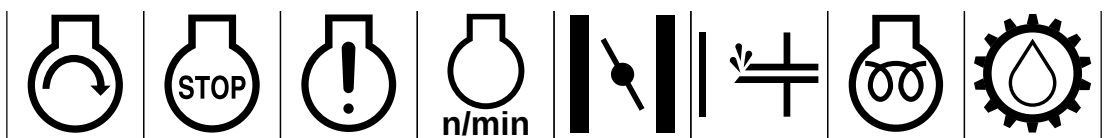
Motorns start Motorns stopp Motorstopp/fel Motorns varvtal/Choke frekvens Tändning (starthjälp) Elektrisk förvärmning (starthjälp, låg temperatur) Transmissionsolja
