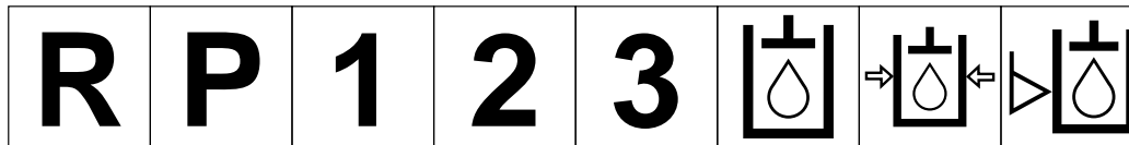
Rückwärts Parken 1. Gang 2. Gang 3. Gang (andere Nr. können bis höchstem Vorwärtsgang gewählt werden) Hydrauliköl Hydrauliköldruck Hydraulikölstand
