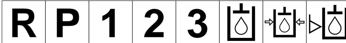
Retromarcia    Parcheggio    Prima    Seconda    Terza (usare le altre marce fino a raggiungere il numero massimo di cambi di marcia)    Olio idraulico    Pressione olio idraulico    Livello olio idraulico
