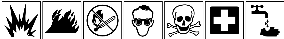
EXPLOSION FEU OU FLAMME NUE INTERDICTION DE FUMER, DE FEU & DE FLAMME NUE PORT DE LUNETTES DE PROTECTION OBLIGATOIRE ATTENTION, DANGER TOXIQUE PREMIERS SECOURS RINCER A L'EAU
