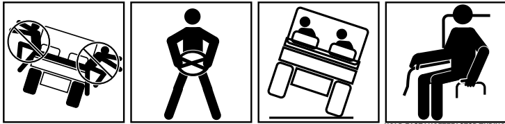
SPRING IKKE NED FRA MASKINEN, HVIS DEN ER VED AT VÆLTE HOLD GODT FAST OG STEM FØDDERNE MOD GULVET MAN SKAL LÆNE SIG VÆK FRA DEN SIDE, MASKINEN HÆLDER IMOD HOLD FAST I HØFTEFASTSPÆNDINGSANORDNINGEN OG HÅNDTAGET, STEM FØDDERNE MOD GULVET
