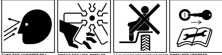
FARE FOR ANSIGTET FRA UDKASTEDE ELLER FLYVENDE GENSTANDE RISIKO FOR LEMLÆSTELSE AF FINGRENE ELLER HÆNDERNE FRA MOTORVENTILATOR PÅ MASKINER MED SIDDENDE FØRER MÅ DER KUN KØRES MED EN PASSAGER, HVIS DER ER ET PASSAGERSÆDE OG FØRERENS UDSTYR IKKE ER SPÆRRET INDEN DER UDFØRES VEDLIGEHOLDELS- ELLER REPARATIONSARBEJDE, AFBRYD MOTOREN OG FJERN NØGLEN.
