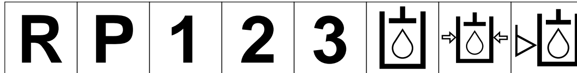
Bakover Parkering 1. gear 2. gear 3. gear (andre nr. kan brukes til maks. antall fremovergear er nådd) Hydraulisk olje oljetrykk Hydraulisk oljenivå
