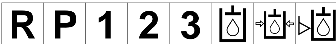
Para trás Estacionamento Primeira mudança Segunda mudança Terceira mudança (podem ser utilizados outros números até que o número máximo de mudanças para marcha para frente seja atingido) Óleo hidráulico Pressão do óleo hidráulico Nível do óleo hidráulico
