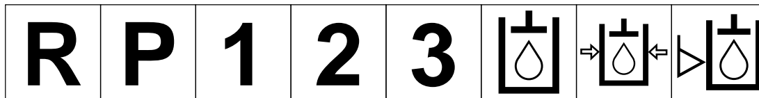
Atrás Estacionamiento Primera velocidad Segunda velocidad Tercera velocidad (pueden utilizarse otras hasta alcanzar el número máximo de velocidades adelante) Aceite hidráulico Presión del aceite hidráulico Nivel del aceite hidráulico
