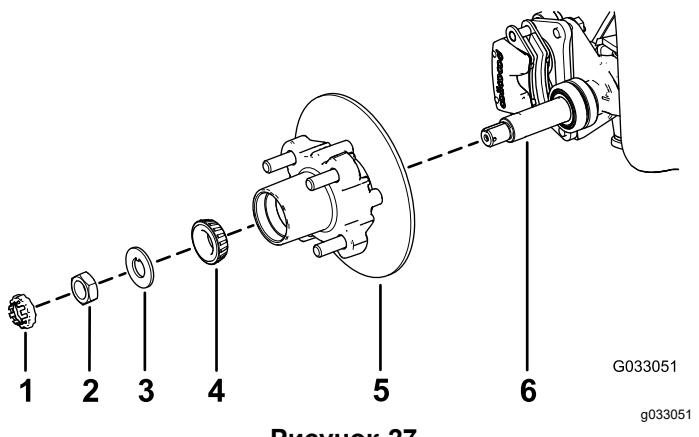
2. Установите ступицу и тормозной диск на ось так, чтобы тормозной диск был внутри (Рисунок 27).
