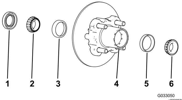
2. Снимите уплотнение и внутренний подшипник со ступицы (Рисунок 26).
