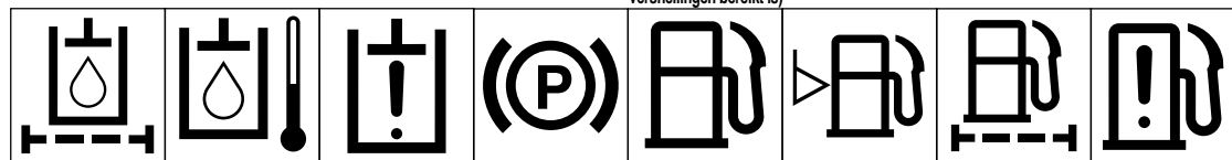
Hydraulisch oliefilter Hydraulische olietemperatuur Defect hydraulische oliedruk Parkeerrem Brandstof Brandstofpeil Brandstoffilter Defect brandstofsysteem
