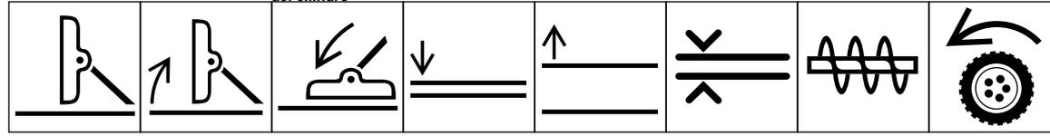
Posizione di trasporto apparato di taglio    Apparatto di taglio: sollevare per il trasporto    Apparatto di taglio: abbassare per il trasporto    Abbassare attrezzo    Alzare attrezzo    Distanza    Spazzaneve, coclea collettrice    Trazione
