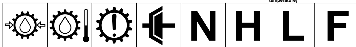
Pressione olio della trasmissione Temperatura olio della trasmissione Avaria trasmissione Frizione Folle Alto Basso Avanti
