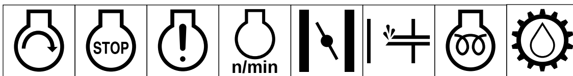
Démarrage du moteur Arrêt du moteur Défaillance/panne du moteur Fréquence/régime du moteur Starter Aide au démarrage Préchauffage électrique (aide au démarrage à basse température) Huile de transmission
