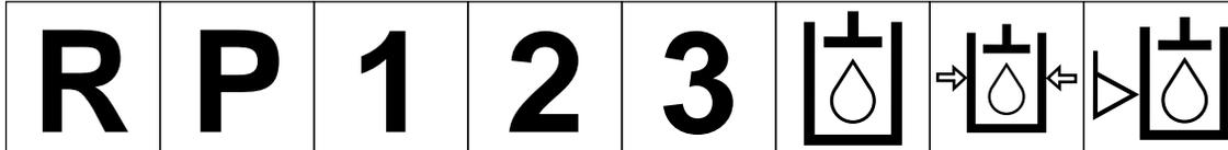
Marche arrière Parking 1ère 2ème 3ème (jusqu'au nombre maximum de rapports de marche avant) Huile hydraulique Pression d'huile hydraulique Niveau d'huile hydraulique
