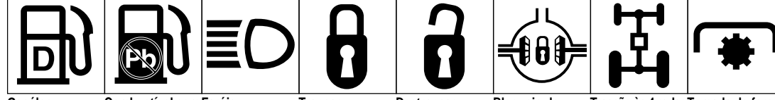
Gasóleo Combustível sem chumbo Faróis Trancar Destancar Bloqueio do diferencial Tracção às 4 rodas Tomada de força
