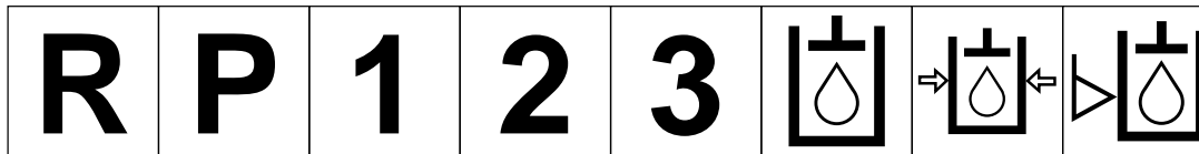
Bakover Parkering 1. gear 2. gear 3. gear (andre nr. kan brukes til maks. antall fremovergear er nådd) Hydraulisk olje Hydraulisk oljetrykk Hydraulisk oljenivå
