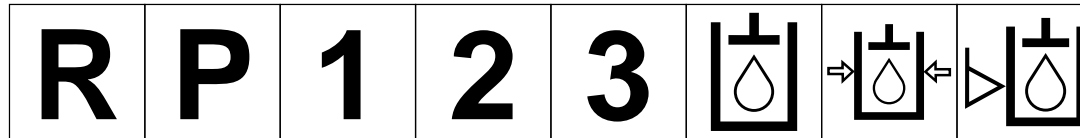
Retromarcia Parcheggio Prima Seconda Terza (usare le altre marce fino a raggiungere il numero massimo di cambi di marcia) Olio idraulico Pressione olio idraulico Livello olio idraulico
