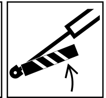
Kiinnitä nostosylinteri lukituslaitteella ennen kuin tulet vaara-alueelle
