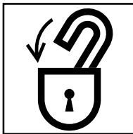
VOR EINTRITT IN DEN GEFAHRENBEREICH MIT SICHERHEITS- SCHLOSS VERRIEGELN
