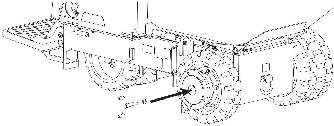
10. Montez la roue extérieure et fixez-la en place avec les boulons de roue retirés précédemment.
