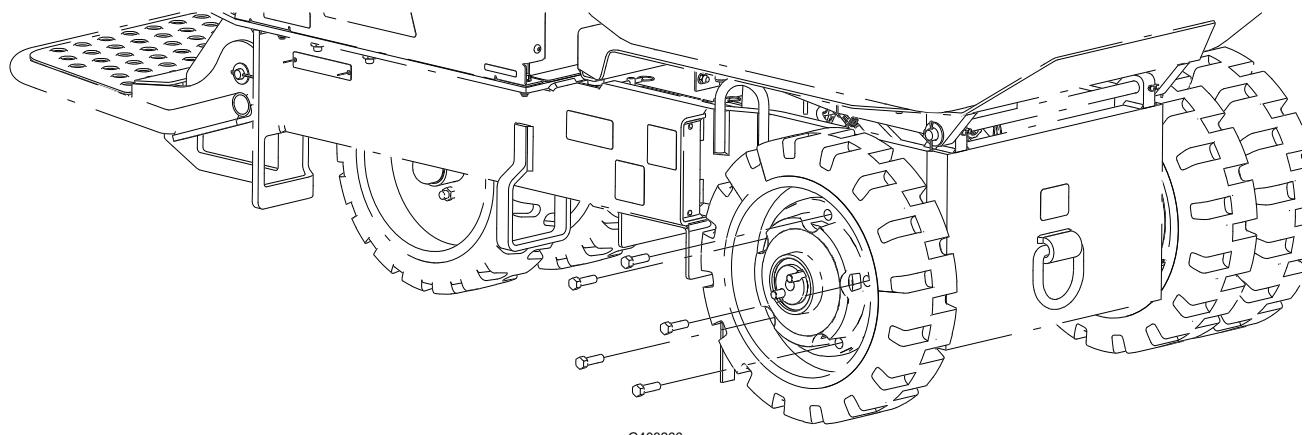
6. Serrez les boulons de roue à un couple de 68 à 79 N·m (50 à 58 pi-lb).
