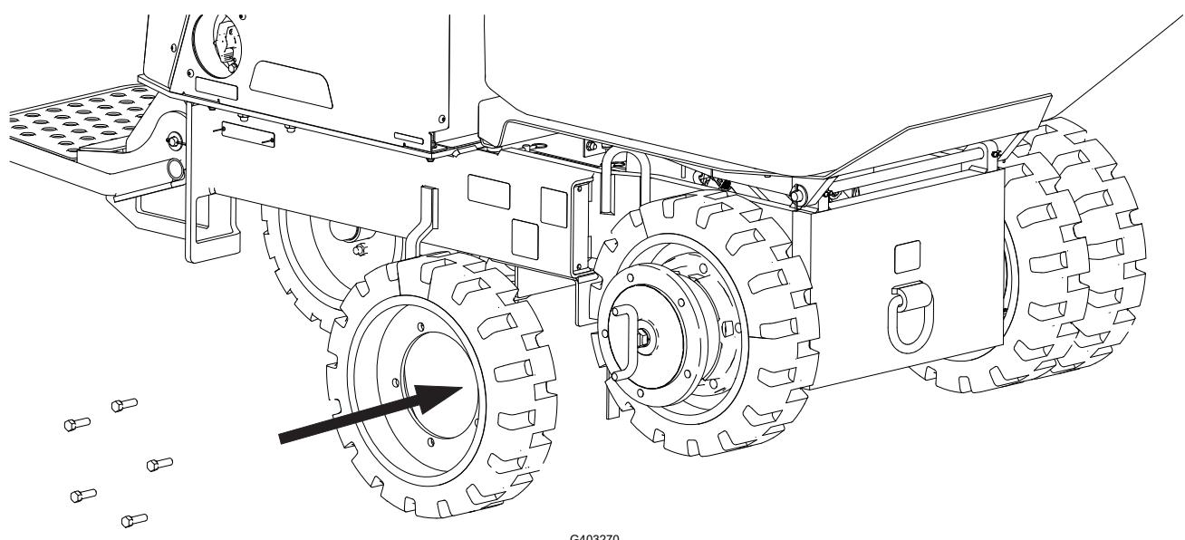
11. Serrez les boulons de roue à un couple de 68 à 79 N·m (50 à 58 pi-lb).
