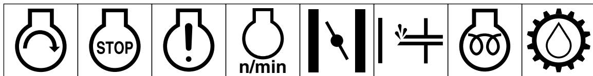
Starten motor Stoppen motor Motorisch defect Motoroerental/ frequentie Choke Injectiepompje (starthulpmiddel) Elektrisch voorgloeien (hulpmiddel starten bij lage temperaturen) Transmissieolie
