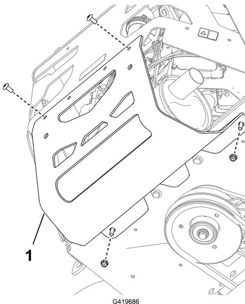
5. Instale el protector de silenciador y soporte de enganche nuevo <sup>①</sup> usando los pernos que se retiraron y contratuercas nuevas.
