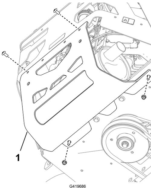
5. Posez la protection neuve du silencieux et le support de l'attelage ① à l'aide des boulons retirés et de contre-écrous neufs.
