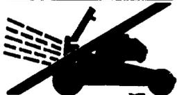
Si le sac à herbe n'est pas installé, ne jamais ouvrir la porte de chute de la tondeuse lorsque le moteur tourne.
