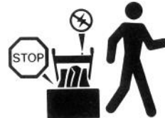
Pysäytä moottori ennen poistokourun puhdistusta
