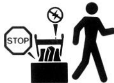
Stäng av motorn före rensning av utkastarröret
