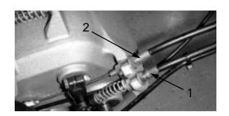
図 48 1. 走行ケーブル 2. ブレーキ・ケーブル
