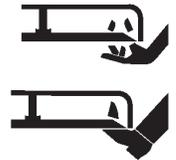
Benutzen Sie, um einen Messerbruch beim Mulchen zu vermeiden, Messerverstärkungen, wenn der Mäher mit einem Mulchverschluss ausgerüstet ist
