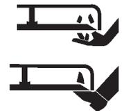
Para evitar el fallo de la cuchilla al picar, utilice el refuerzo de la cuchilla siempre que el cortacésped tenga instalado el tapón de picar hierba
