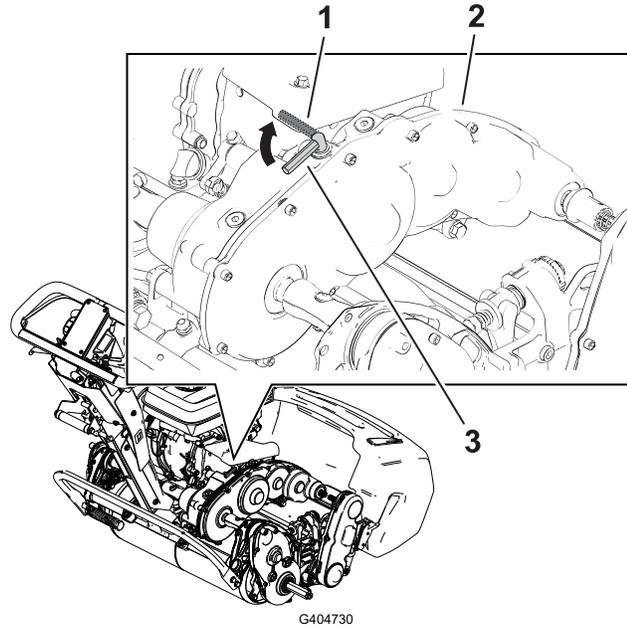
① 트랙션 작동 레버 - DISENGAGED(해제) 위치
