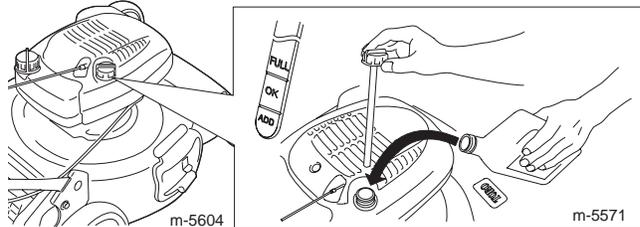
2. Retire la varilla y compruebe el nivel de aceite. Si el nivel de aceite está por debajo de la marca **Add** de la varilla, vierta **lentamente** aceite en el tubo de llenado hasta que el nivel llegue a la marca **Full** de la varilla. **No llene demasiado.** (Capacidad máxima: 20 onzas (0,59 l) de aceite detergente tipo SAE 30, con clasificación de servicio API de SF, SG, SH o SJ.)
