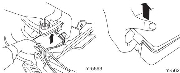
2. Inserte el fusible en el portafusibles según muestra la ilustración.
