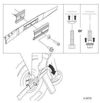
**6.** A l'aide d'une clé dynamométrique serrez le boulon de la lame à 82 Nm (60 ft-lb.).
