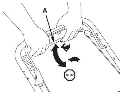
Para desengranar la transmisión autopropulsada, suelte la barra de control de transmisión autopropulsada.
