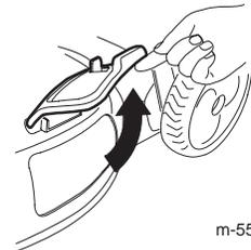
3. Instale el conducto de descarga lateral y cierre la puerta sobre el conducto.
