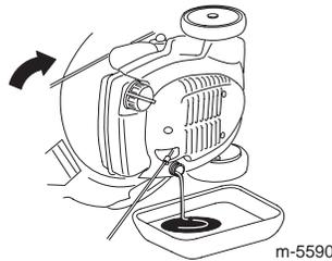
3. Vierta **lentamente** aceite en el tubo de llenado hasta que el nivel llegue a la marca **Full** de la varilla. **No llene demasiado.** (Capacidad máxima: 0,59 litros (20 onzas), tipo: SAE 30W, aceite detergente con clasificación de servicio API SF, SG, SH o SJ.)
