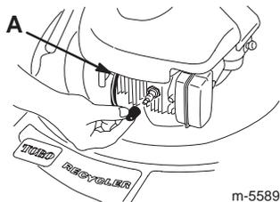
3. Después de realizar el/los procedimiento(s) de mantenimiento, conecte el cable de la bujía a la bujía.
