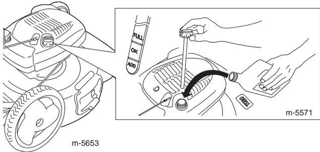
2. Retire la varilla y compruebe el nivel de aceite. Si el nivel de aceite está por debajo de la marca **Add** de la varilla, vierta **lentamente** aceite en el tubo de llenado hasta que el nivel llegue a la marca **Full** de la varilla. **No llene demasiado.** (Capacidad máxima: 0,59 litros (20 onzas), tipo: SAE 30, aceite detergente con clasificación de servicio API SF, SG, SH o SJ.)
