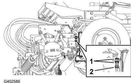
2. Afloje la tuerca autoblocante ② en la varilla del cilindro de elevación ①.
