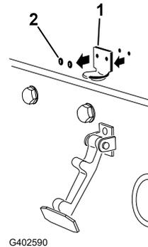
3. Mientras alinee los taladros de montaje, coloque el el cierre de seguridad para CE (1) y el soporte del cierre sobre el capó.
