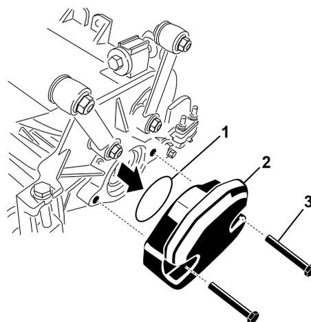
5. Inserte la junta tórica (1) en la brida del motor de la transmisión (2).
